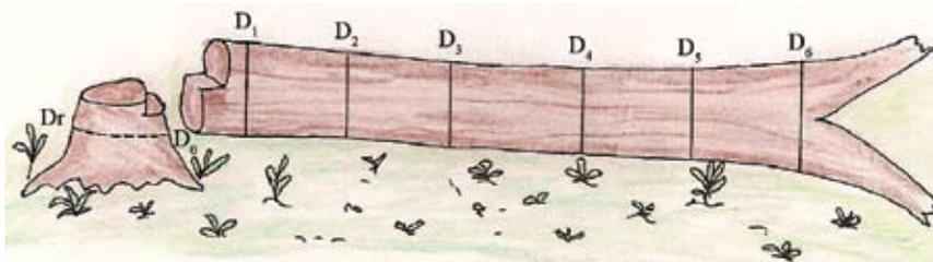
Figura 4. Medición del diámetro de la troza
