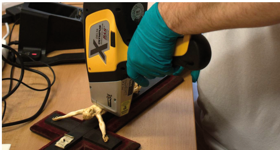
Measurement of ivory using a Delta X-ray fluorescence spectrometer (photo: Pavla Říhová)
